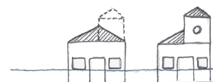
Critère D, bâtiment capable de résister à la submersion avec pièce ou issue de sécurité.
